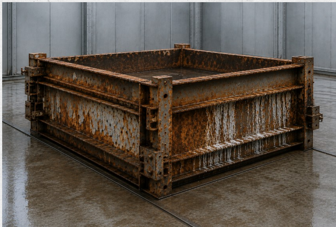
Rys 3. Skorodowana forma stalowa [8].
